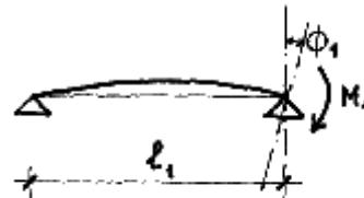
4.6 Deformación de viga con extremo articulado y momento aplicado en el otro.
