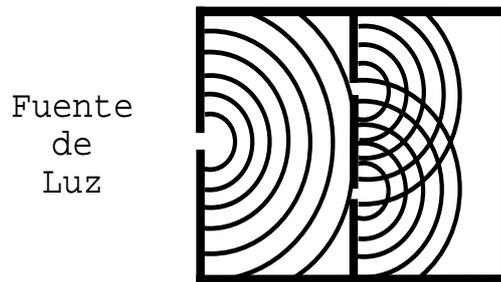
Figure 1.1: Experimento de las 2 ranuras, el patrón de interferencia generado por la luz se puede explicar suponiendo que la luz se propaga mediante ondas
