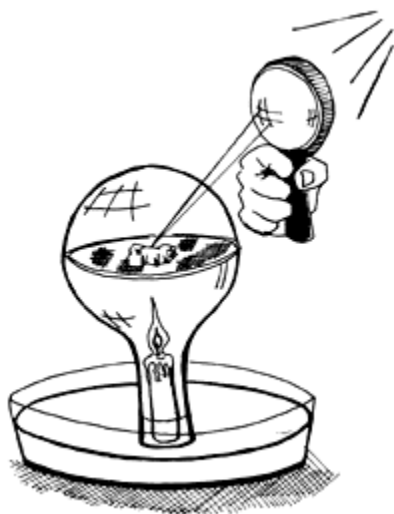
Figura 13. Experimento de Mayow. Al arder la vela o al arder el trozo de azufre se producen gases que se disuelven en el agua, por lo que el nivel de ésta sube por el cuello del matraz.
