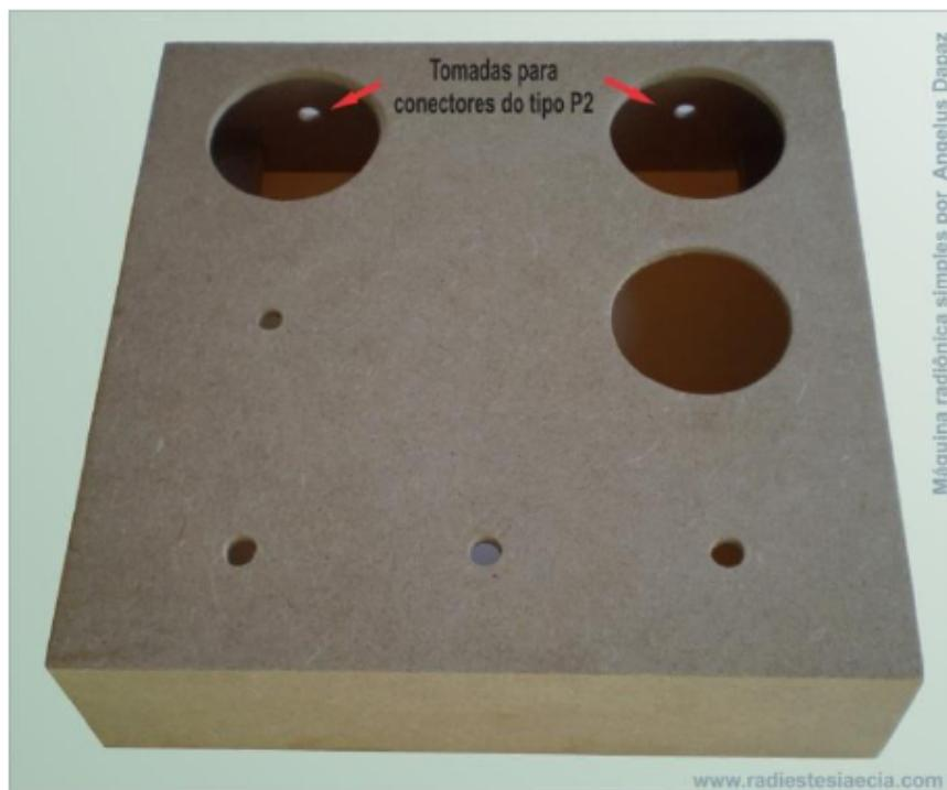
Note-se que os furos pequenos que aparecem no fundo da caixa, na imagem acima, são destinados à fixação das tomadas para conectores do tipo P2 e devem ser alinhados com os centros de seus respectivos potes. Nesse dispositivo os potes de entrada a esquerda e saída à direita, tem suas equivalentes tomadas para conectores P2, ou seja, podem-se usar cabinhos do tipo P2 para conexão com o testemunho do “*sujeito*” e ao “*objetivo*”.
