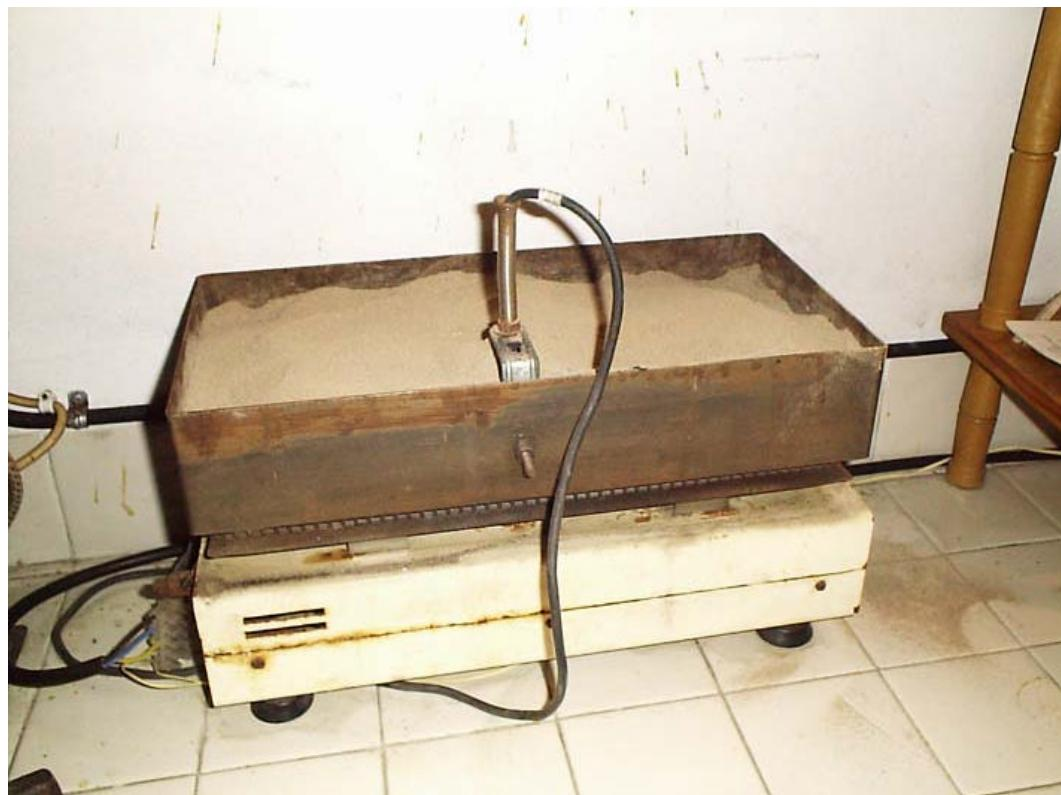
Fig. 3 Baño de arena eléctrico con regulador de temperatura.
