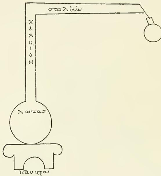
FIGURE 16. — Appareil distillatoire. Réduction aux 2/3.
