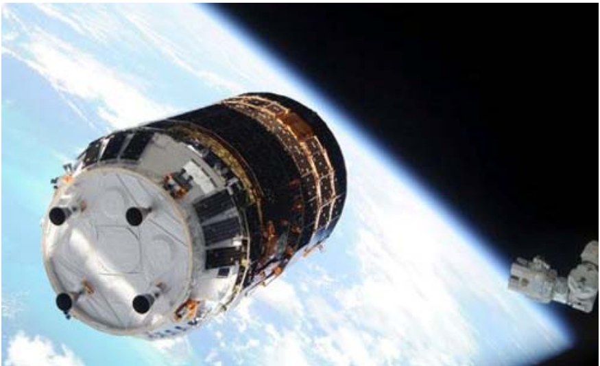
Imagen: El brazo robótico de la ISS (derecha) se dispone a atrapar al vehículo logístico japonés HTV para acoplarlo a la estación. (Foto: NASA)
