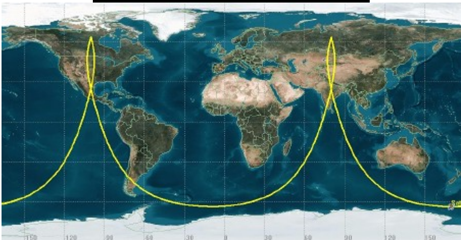
Imágenes: Vista tridimensional y traza terrestre de una órbita Molniya, utilizada principalmente por satélites de comunicaciones rusos. (Imagen: J.Casado)
