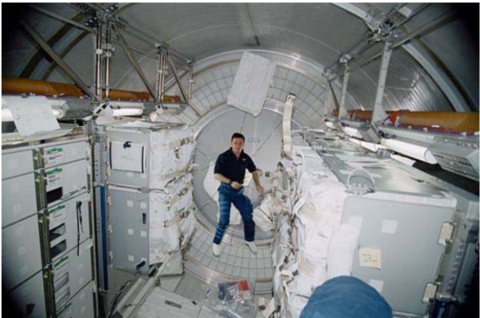
Imagen: Un astronauta en el interior de un MPLM recientemente amarrado en la estación, todavía cargado con buena parte de los suministros destinados al complejo espacial. Pueden observarse las grandes dimensiones de este contenedor espacial. (Foto: NASA)
