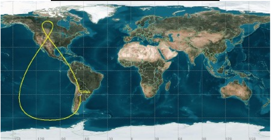
Imágenes: Vista tridimensional y traza terrestre de una órbita Tundra, utilizada por los satélites norteamericanos Sirius con fines similares a las órbitas Molniya rusas. (Imagen: J.Casado)
