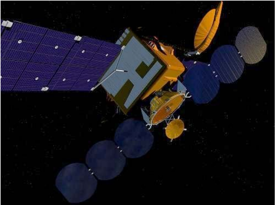
Imagen: ConeXpress se acopla al satélite “cliente” de modo que sus paneles solares queden en ángulo recto con los de aquel, para evitar hacerse sombra. (Imagen: Orbital Recovery Ltd )
