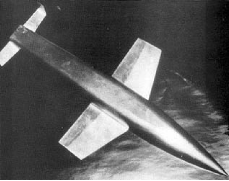
Imagen: Maqueta para túnel de viento del Silbervogel de Eugen Sänger. (Foto: archivos del autor)
