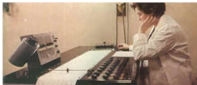
Aparato de encefalografía con el que se miden las ondas y frecuencias cerebrales
