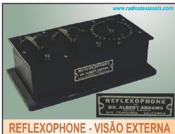
O Reflexophone, mostrado na figura acima, se constituía de uma caixa em madeira na cor preta, medindo 25 cm x 15 cm x 10 cm, com tampa em material impregnado com resina fenólica com números estampados, três diais com ponteiros e dois conectores para cabos. O seu primeiro dial selecionava resistências de 0 a 50 Ohms, o segundo de 0 a 10 Ohms e o terceiro de 0 a 2,5
