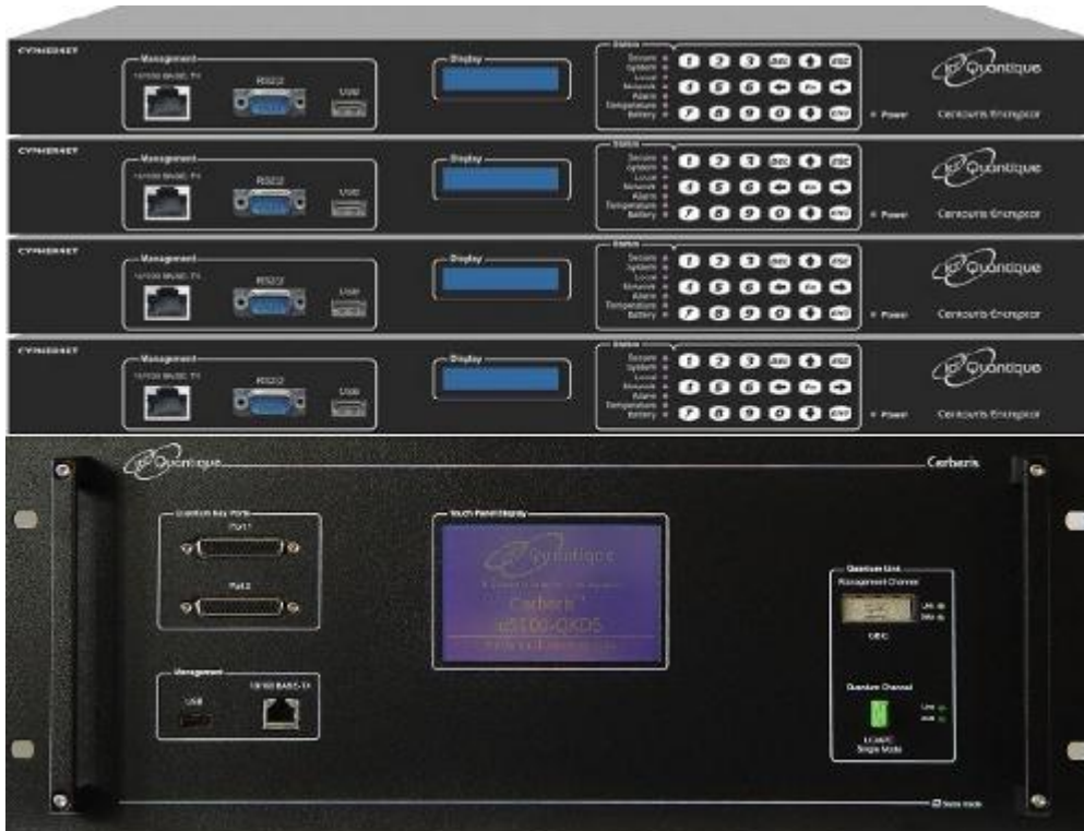
Cerberis, sistema de criptografía cuántica de id Quantique .
