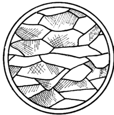
Microestructura de metal martillado en frío
