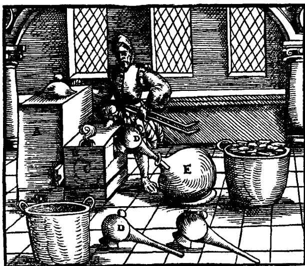
Obtención del agua fuerte (ácido nítrico) según Lazarus Ercker, «De arte subterranea», Fráncfort del Meno.
