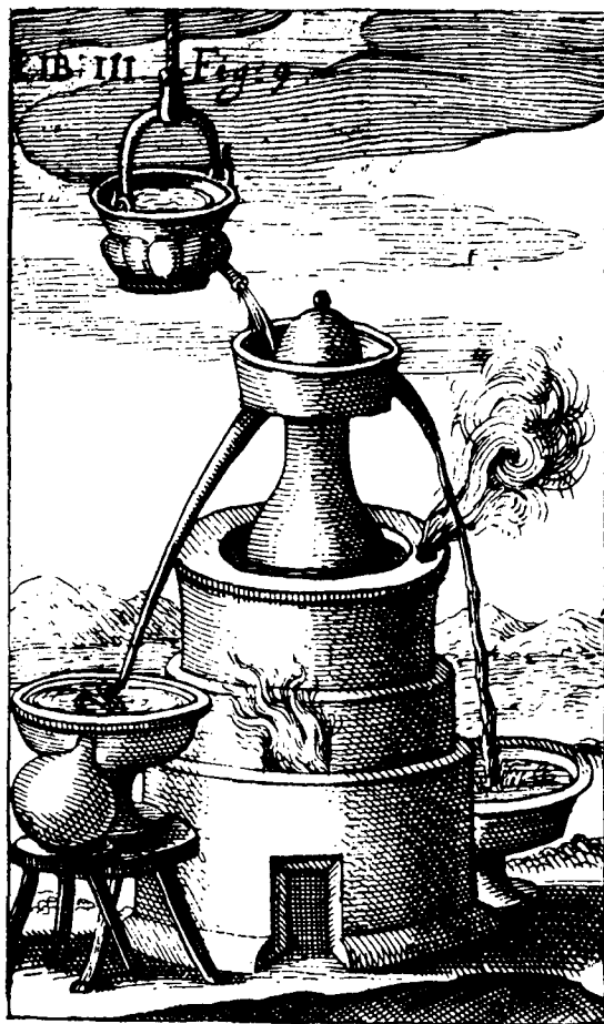
Dispositivo de destilación con caperuza refrigerada en agua, el llamado «Mohrenkopf». (Grabado anónimo, 1625.)
