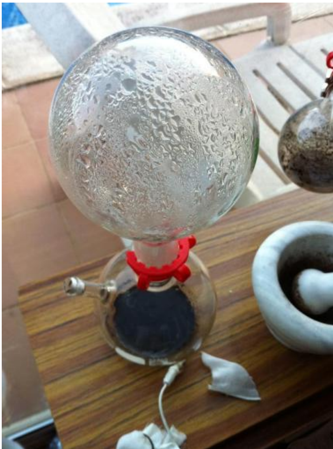
Ilustración 159 Condensación y tierra en balón doble.
