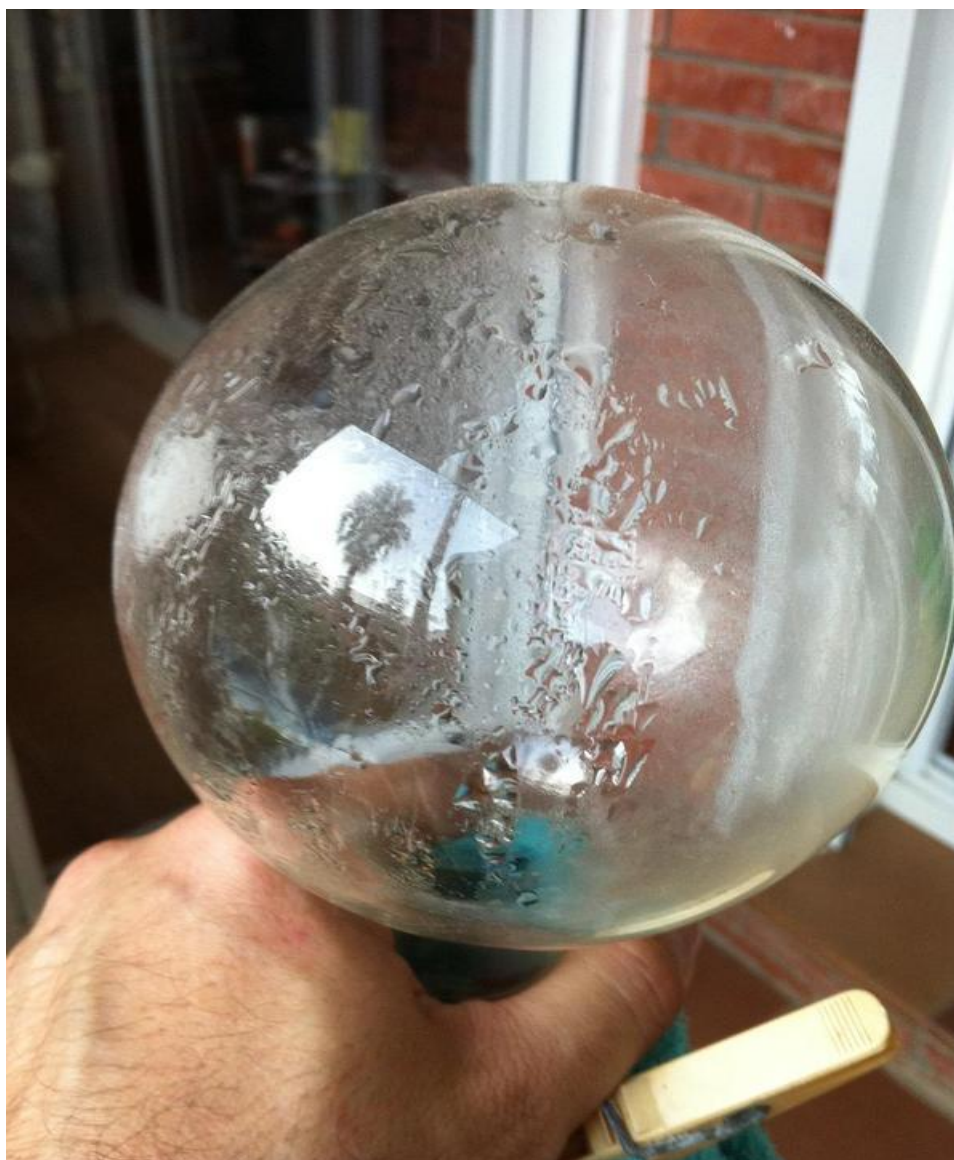
Ilustración 202 Humedad en el balón superior.
