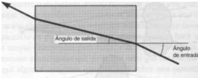
Figura 5.10. Desviación de la luz. Principio de refracción en un bloque de cristal.
