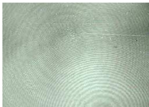
**Figura 29 (izq.):** La onda o patrón de 'interferencia' sobre una impresión holográfica. Parece aleatorio y sin sentido hasta que el patrón sea iluminado con una luz de láser y se forma un holograma.
