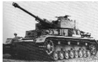
Panzerkampfwagen Ausf D con cañon largo 75mm.
