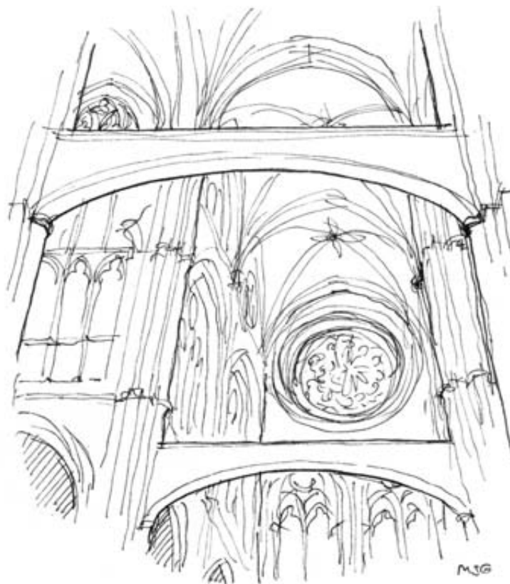
Arcos de refuerzo en el crucero.
